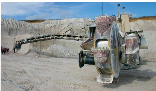
Mit dem Schaufelradbagger SRs 130 wird im Tagebau Schleben/Crellenhain Kaolin gewonnen.
